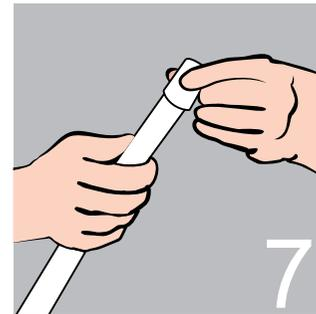
На прогретый сварочный аппарат, не вращая, одновременно плавно поместите трубу и фитинг РВК на соответствующие насадки.
